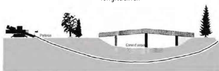
Schema del tracciato della trivella
